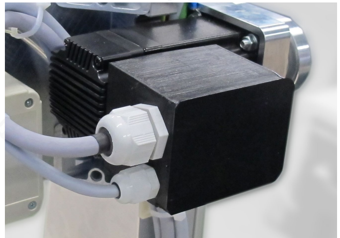
Bild 7: Die Abdeckung schützt gegen Staub und Späne.
