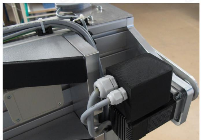
Bild 7: Die Abdeckung schützt gegen Staub und Späne.
