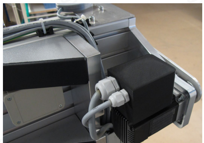
Bild 7: Die Abdeckung schützt gegen Staub und Späne.
