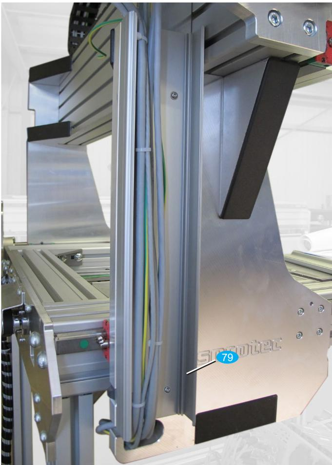
Bild 3: Kabelführung durch Kabelkanal. Zur besseren Übersicht fehlt die Abdeckung.
