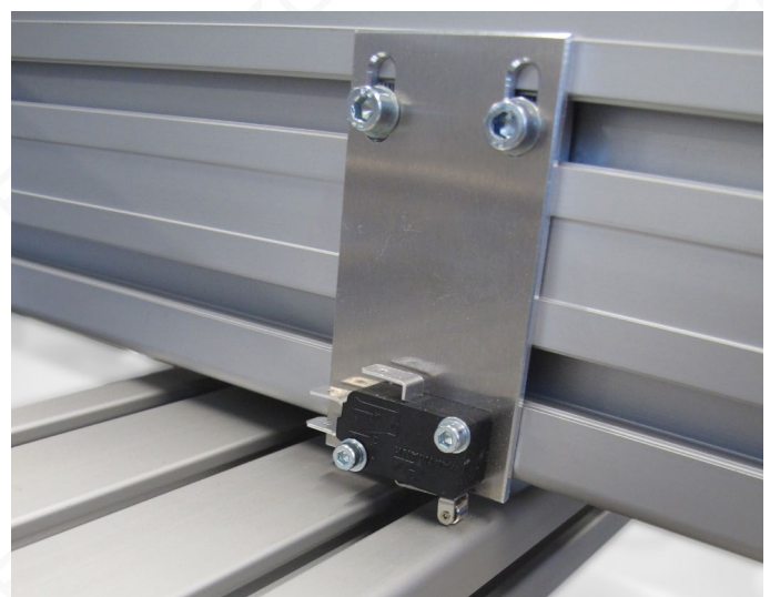
Bild 7: Auslösung des Referenzschalters durch den Unterzug
