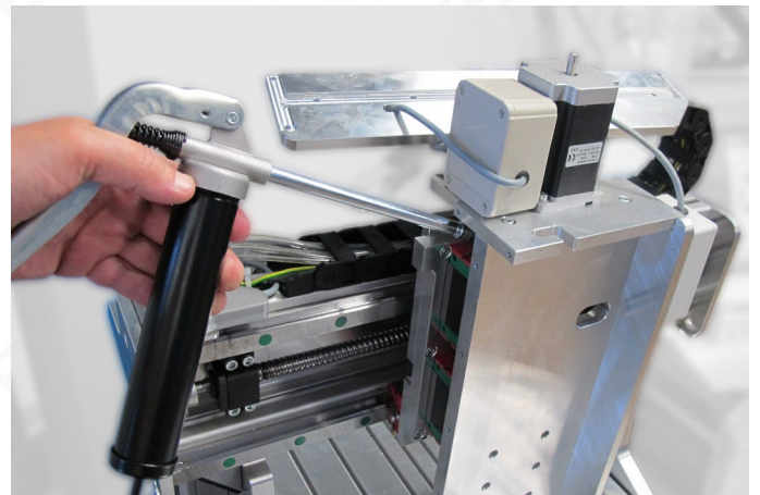
Bild 7: Abschmieren der linken Z-Führungen
