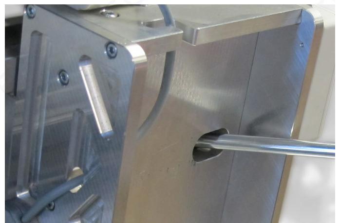
Bild 8: Abschmieren Spindelmutter Z-Achse
