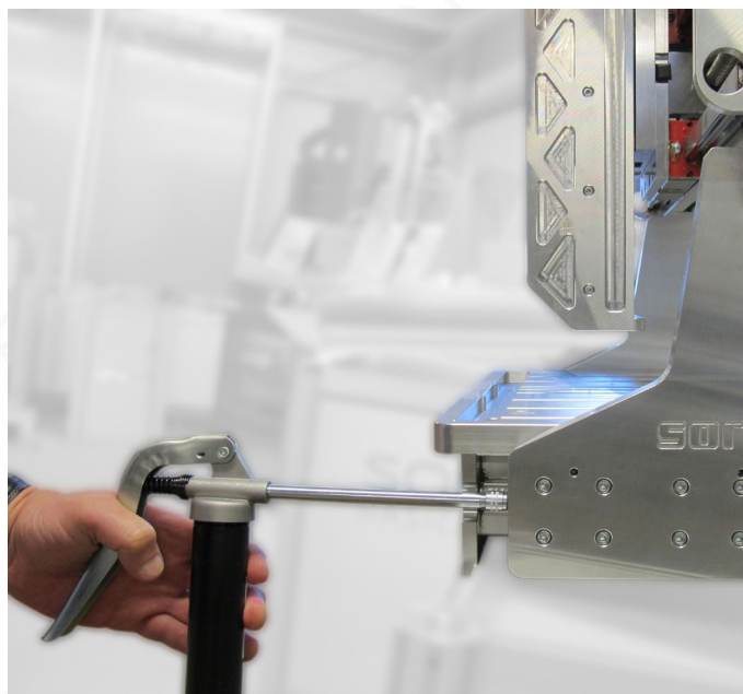
Bild 1: Abschmieren Führungswagen X-Achse
