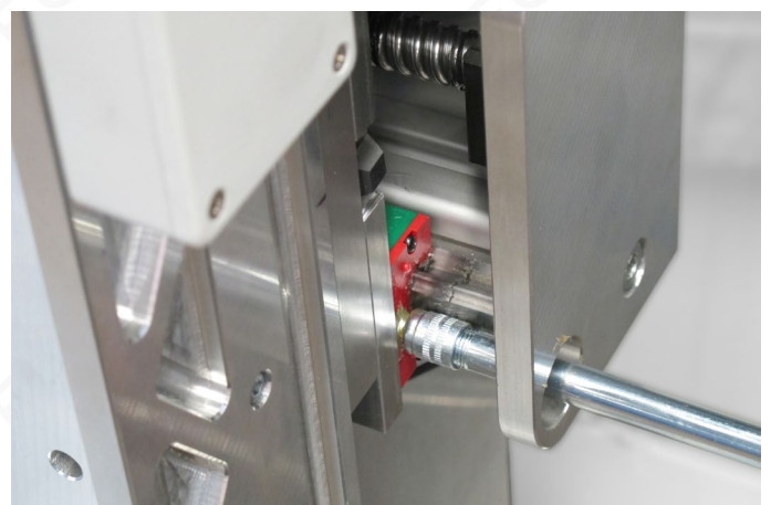
Bild 5: Abschmieren der Y-Führung
