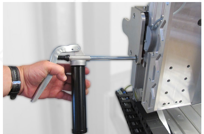
Bild 4: Abschmieren der Y-Führung
