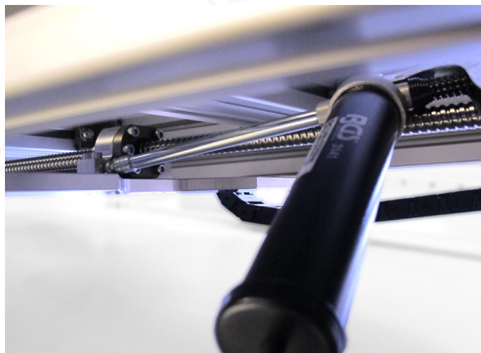
Bild 45: Abschmieren der X-Spindelmutter bei nach vorne geneigter Maschine
