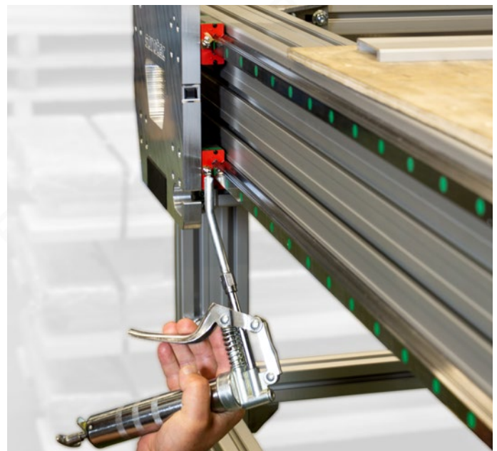
Bild 2: Abschmieren Führungswagen X-Achse
