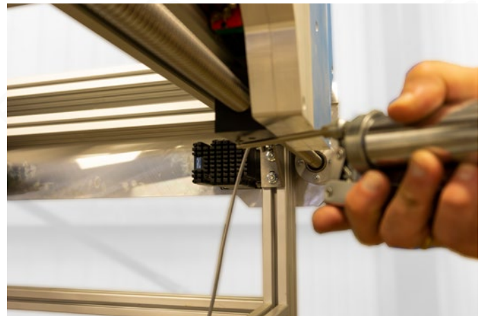
Bild 4: Abschmieren der rechten X-Spindel (Gantry-Version)
