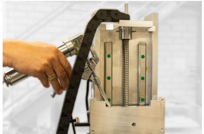
Bild 9: Abschmieren Spindelmutter Z-Achse
