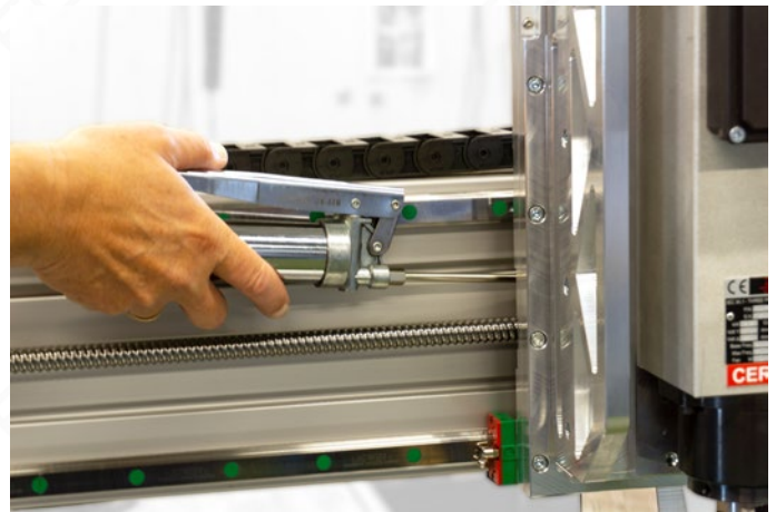
Bild 6: Abschmieren der Y-Spindelmutter
