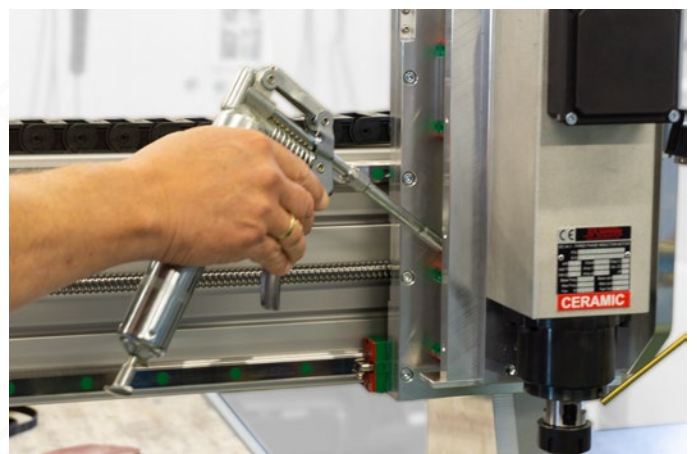
Bild 8: Abschmieren der linken Z-Führungen
