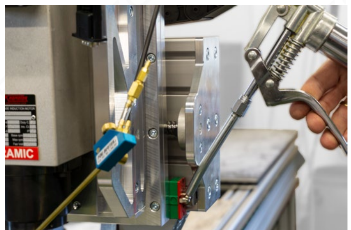
Bild 5: Abschmieren der Y-Führung
