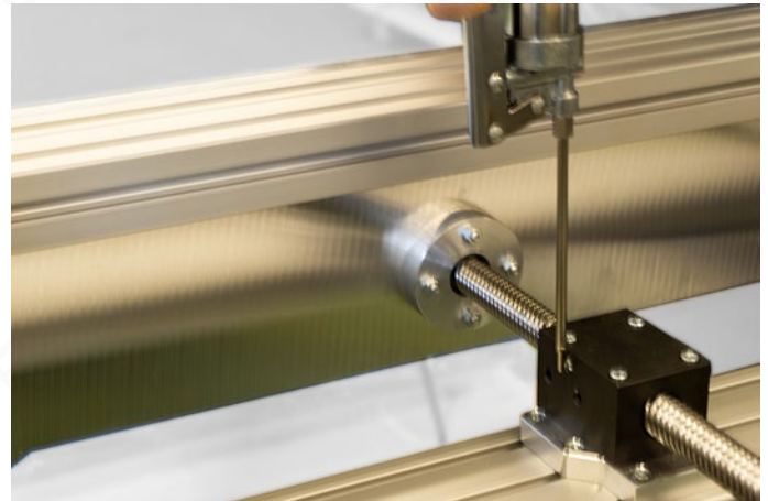
Bild 3: Abschmieren der Mittelspindel von oben
