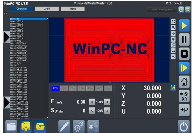
Bei den Daten können einzelne Werkzeuge oder Ebenen ein/ausgeblendet, das Werkstück wie gewünscht positioniert und natürlich zur Kontrolle gezoomt und im Raum gedreht werden.
