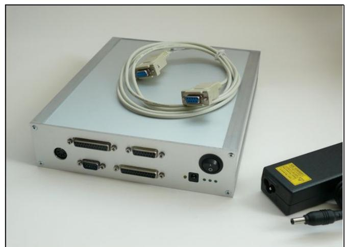
Je nach Kundenanforderung bieten wir für jede Anwendung verschiedene Varianten und Erweiterungen unseres Achscontrollers. Es können zB. digitale Ein-/Ausgänge mit 24Volt-Logik nachgerüstet werden oder 0-10 Volt Analogausgänge für die Drehzahl- und Leistungssteuerung. Auch viele Sicherheitsfunktionen wie Schutzhaube, Füllstände, Druckluft, Positionen und externe Komponenten werden permanent überwacht und mit definierbaren Warnmeldung versehen.
