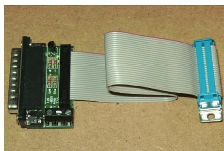
Auf dem TripleBeast muss der Jumper-Stift Nr. 9 mit dem Stift Nr. 2 mit einer Drahtbrücke verbunden werden. Die Jumper 4-5 und 6-7 müssen gesteckt sein, die Stifte 1, 3 und 8 bleiben frei. Die restlichen Jumper 10-11 und 12-16 können wie oben
