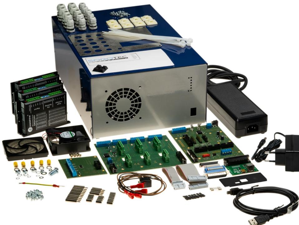
Bild 1: Der Teilesatz für die Steuerung Mini-Control
