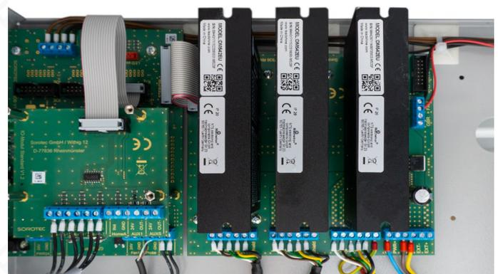
Bild 27: Aufgesteckte Endstufen
