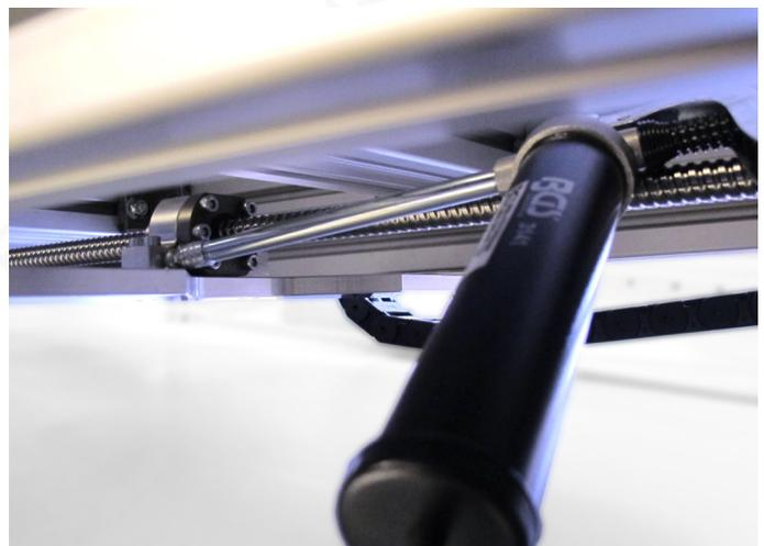
Bild 45: Abschmieren der X-Spindelmutter bei nach vorne geneigter Maschine
