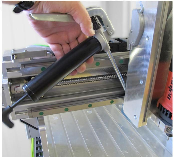
Bild 46: Abschmieren Führungswagen Y-Achse
