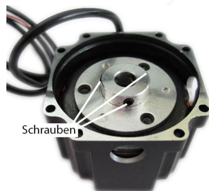
Bild 3: V2 Bremsscheibe mit drei Klemmschrauben
