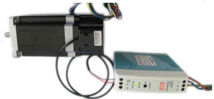
Bild 6: Behelfsmäßig Spannung anlegen, Bremse lösen
