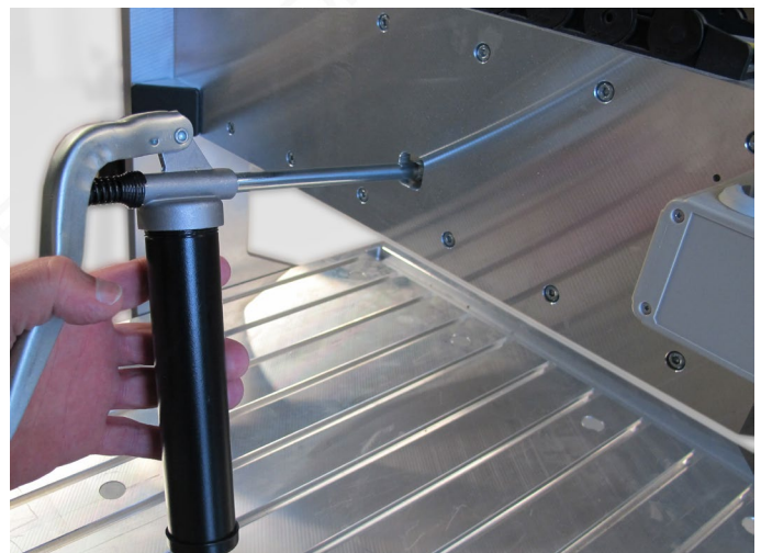
Fig. 47: Lubricating the Y spindle nut
