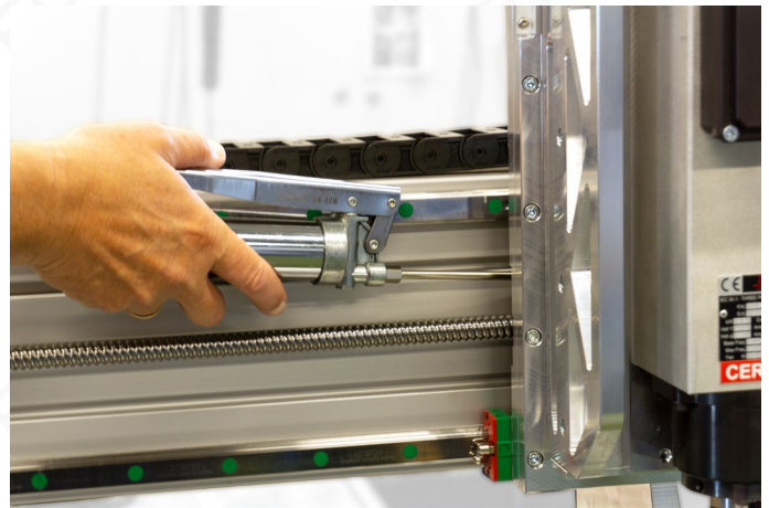
Fig. 6: Lubricating the Y spindle nut
