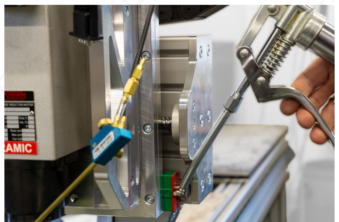
Fig. 5: Lubricating the Y guide
