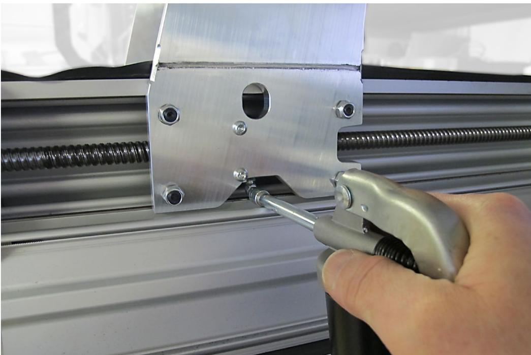
Bild 3: Abschmieren der Y-Achse rechts
