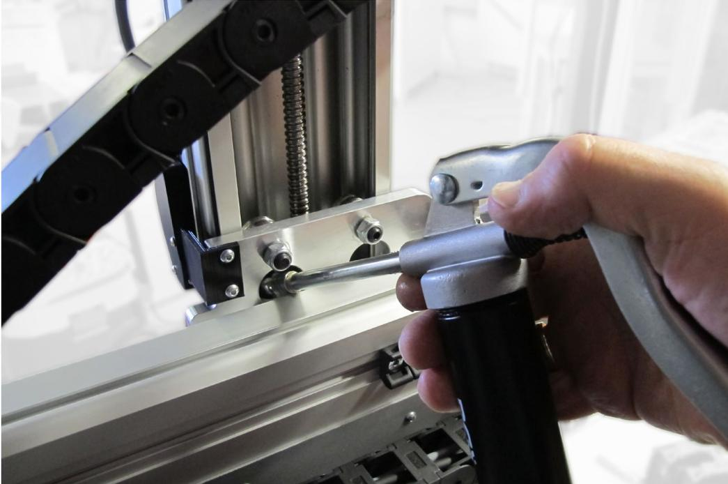
Bild 4: Abschmieren der Z-Achse
