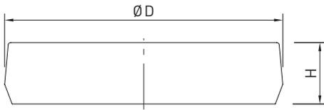
Tabelle 3.101 Abdeckkappen für die Montagebohrungen von Profilschienen
