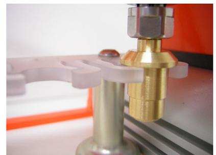
Fahren Sie nun den Einmesszapfen im manuellen Modus knapp über den Werkzeugablageplatz 1 (ganz rechts im Magazin), wie auf dem Bild gezeigt.
