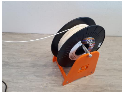
Der Filamentrollenhalter ist so positioniert, dass das Filament ohne Widerstand abrollen kann.
