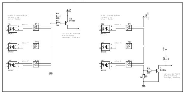
Das obige Bild zeigt zwei Schaltungsbeispiele, eines für 24V-Pegel (Beamicon, SPS-Systeme) und eines für 5V-Pegel (PC Parallelport, Mach3 ohne Breakoutboard oder von anderem Hersteller). Die Statusausgänge der BIGBEAST-Endstufen werden dabei in Reihe geschaltet. Ein Fehler mindestens einer Endstufe, die Unterbrechung eines Kabels oder ein Spanungsausfall führt dabei sicher zu einer Alarmmeldung an die Steuerung.
