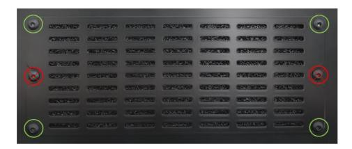
Die Filtermatte ist zur Reinigung zu entnehmen und anschließend mit z.B. einem Staubsauger oder einer Druckluftpistole gereinigt werden. Nach der Reinigung ist die Filtermatte wieder einzulegen und das Lüftergitter handfest anzuschrauben. Das Xcool darf nicht ohne Filtermatte und Lüftergitter betrieben werden.
