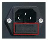
Die alte Sicherung ist zu entfernen und gegen eine neue zu tauschen. Anschließen muss das Sicherungsfach wieder eingelegt werden, bis es einrastet. Das Xcool ist wieder betriebsbereit.
