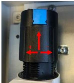
05. Die Steuerleitung ist maschinenseitig zu demontieren.
