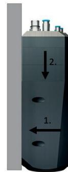
Die Schrauben sind (vorne bzw. hinten) mit einem Drehmoment von 18 bis 20 Nm festzuziehen unter Berücksichtigung von Einschraubtiefe und Plattenmaterial.
