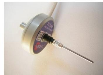
Der 3D-Taster eignet sich auch zum Vermessen von Bohrungen als Referenzpunkt. Die Spitze des 3D-Tasters muss dazu innerhalb der Bohrung platziert werden. Das Macro „Zentrumsfinder“ tastet die Wand der Bohrung an mehreren Stellen an und ermittelt daraus die Lage des Bohrungsmittelpunkts. Nach Ausführung des Macros steht die Meßspitze genau im Zentrum. Die X- und Y-Koordinate können danach entweder auf Null oder (durch Doppelklick) auf die bekannten Koordinaten des Referenzpunkts gesetzt werden.
