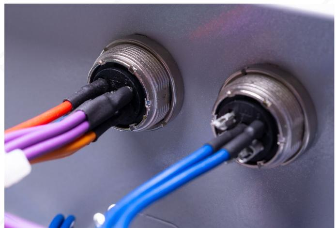
Bild 17: Jeder Pin einzeln mit Schrumpfschlauch isoliert
