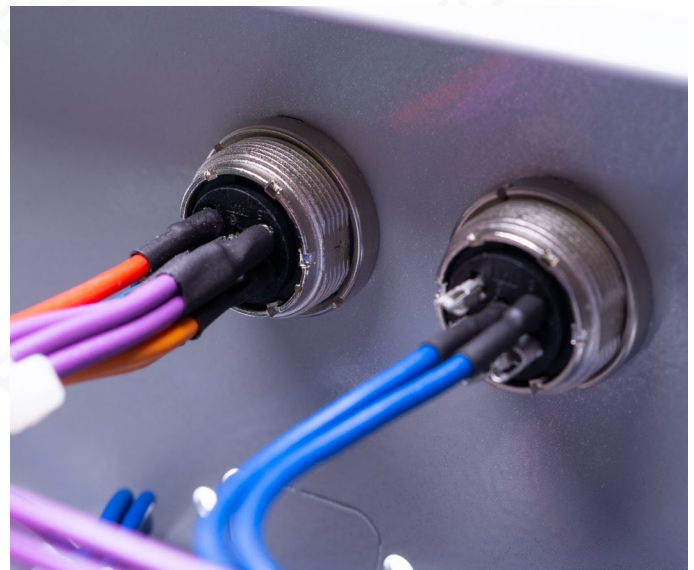
Bild 19: Jeder Pin einzeln mit Schrumpfschlauch isoliert
