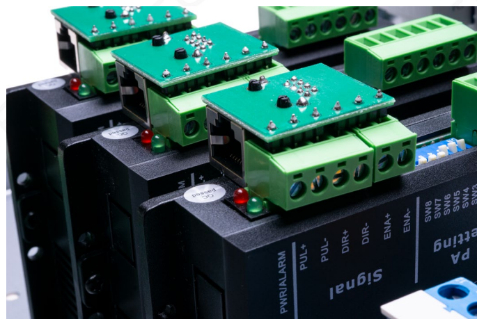
Bild 9: Montage der RJ45-Adapter an der Klemmleiste
