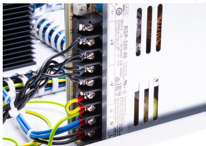
Bild 18: Die Klemmenleiste am Netzteil
