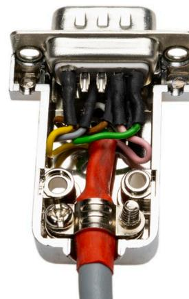
13 Zugentlastung auf Schrumpfschlauch, Gehäusehälfte
