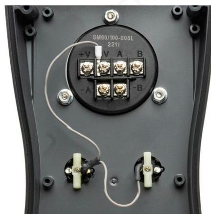
9 Masseverbindung von Drehgeber und Tastern
