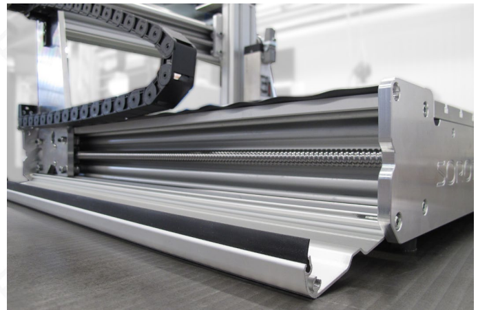
Bild 28: Zur Wartung der Spindeln lassen sich die Seitenabdeckungen nach Entfernen der oberen Schrauben einfach aufklappen.
