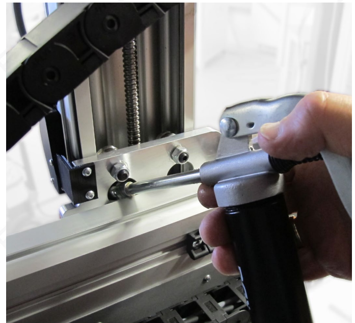
Bild 47: Abschmieren der Z-Achse
