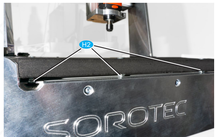
Bild 42: Noch nicht richtig ausgerichtete Hammermuttern
