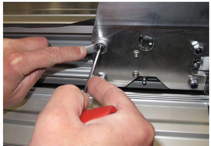
Bild 21: Einstellen der Führungsrollen
