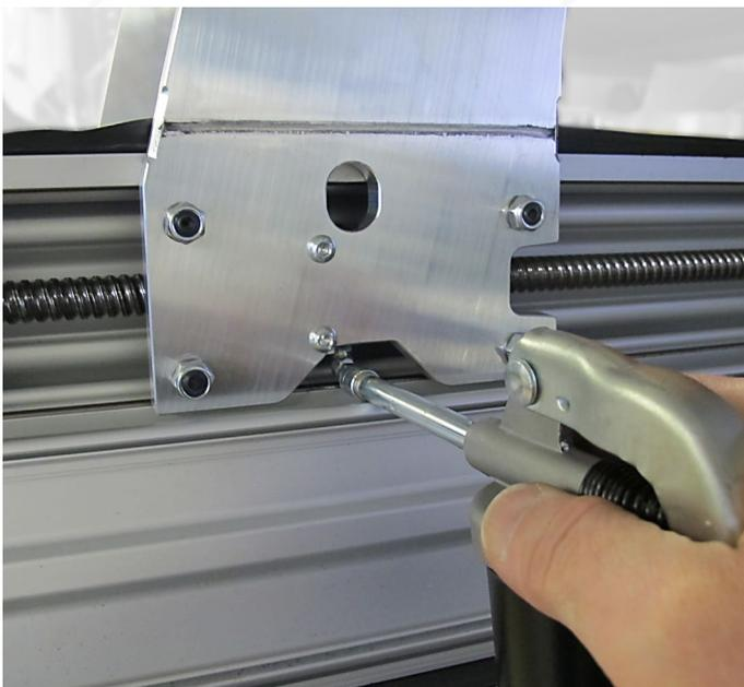
Bild 46: Abschmieren der Y-Achse rechts
