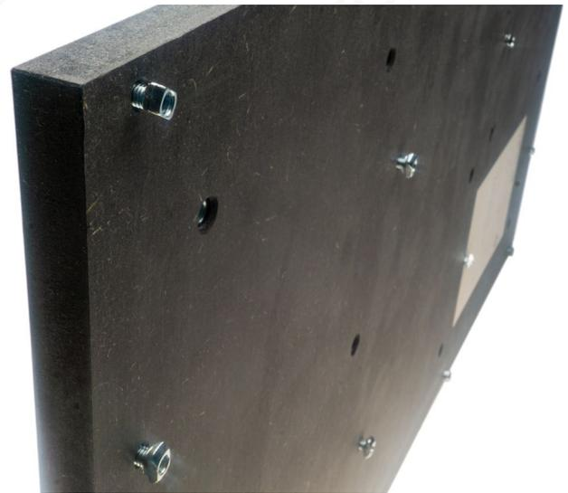
Bild 41: Unterseite einer MDF-Werkstückauflage mit aufgedrehten Hutmuttern
