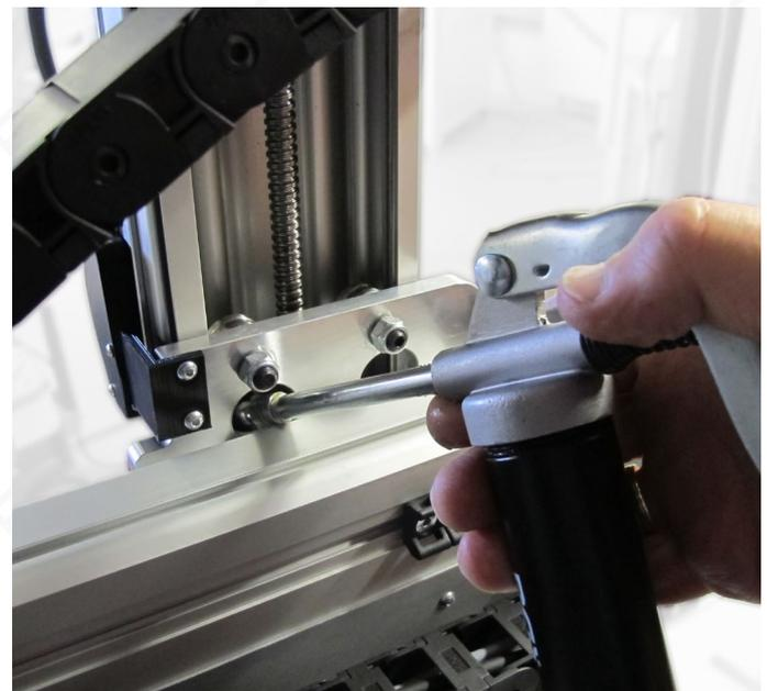
Bild 47: Abschmieren der Z-Achse
