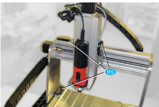
Bild 30: Position der Referenzschalter an der Maschine
