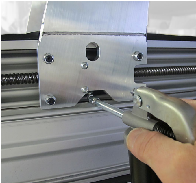
Fig. 43: Lubricating the Y axis - right side.
