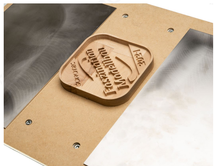
Bild 4: Abdeckung nicht benutzter Bereiche, hier beispielhaft mit Blechen.
