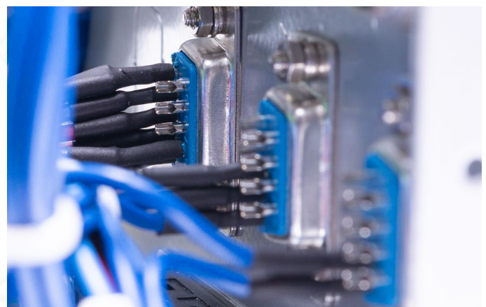
Bild 14: Jeder Pin einzeln mit Schrumpfschlauch isoliert
