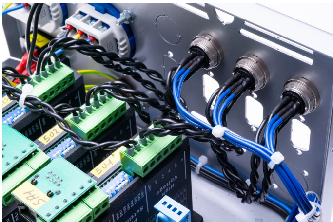
Bild 15: Powerleitungen sind paarweise verdreht
