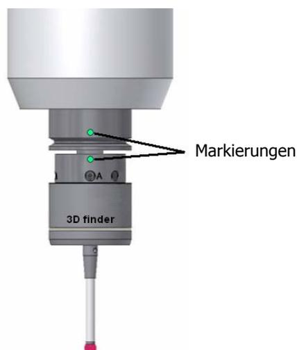
Hiermit ist die Ausrichtung zur Spindelmitte beendet. Als Nächstes müssen Sie die Kalibrierung des wirksamen Radius vornehmen (Radius-Offset).
